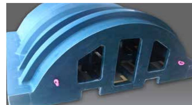
Mateční model z Ebablocku P185 pro prepreg nástroj. Velikost: 3760 x 2990 x 1640 mm. Objem: 3000 litrů.
